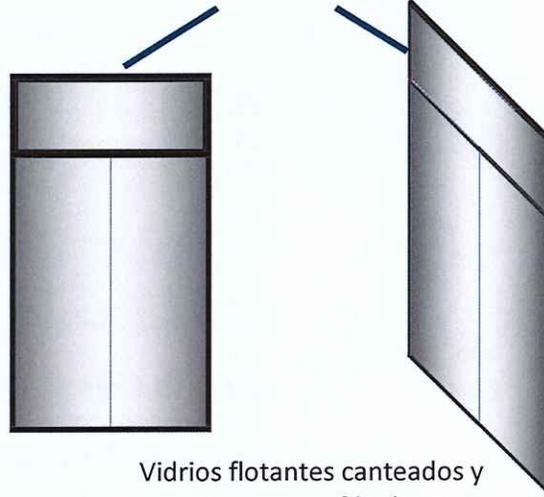
Vidrios flotantes canteados y besados con perfilera P40
